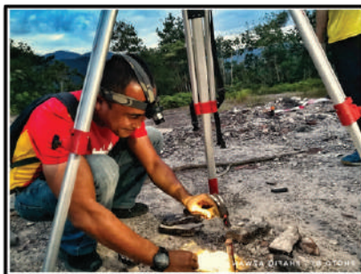
Foto 1: Proses mendirikan stesen rujukan untuk penentuan azimuth.
