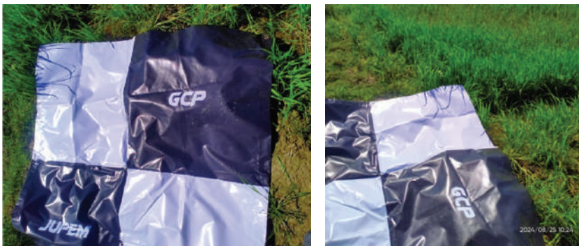
Rajah 3.4: Tanda GCP yang dibina berukuran 1mx1m
