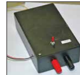
Rajah 8 – Bahagian B yang menempatkan litar bagi alat pengesan cahaya.
