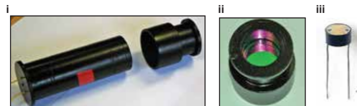
Rajah 7 – Bahagian A. i: kotak peka cahaya dimana LDR ditempatkan. ii: penuras cahaya hijau yang digunakan dan diletakkan dihadapan kotak peka cahaya. iii: photo resistor (LDR) .
