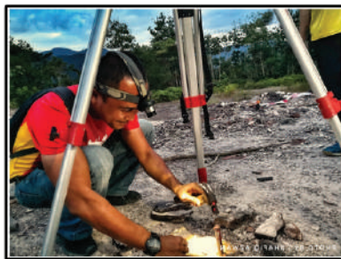
Foto 1: Proses mendirikan stesen rujukan untuk penentuan azimuth
