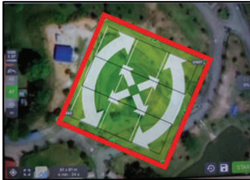
Gambar 7: 7 Misi penerbangan UAV dengan menggunakan aplikasi Pix4Dcapture menggunakan double grid Petak merah adalah kawasan kerja, manakala garisan grid adalah laluan penerbangan UAV.
