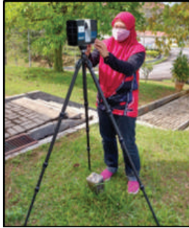
Gambar 8: Diri siap Faro Focus M70 di lapangan Sumber: Dokumen pribadi
