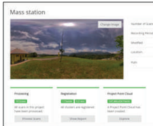
Gambar 19: Hasil akhir registration yang dilakukan iaitu 5.2mm dan jumlah point cloud iaitu jutaan point cloud .
