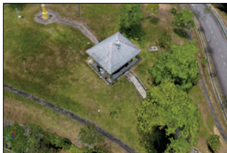
Gambar 18: Integrasi mesh dan point cloud menghasilkan colorize imej. Sumber: Perisian Pix4Dmapper
