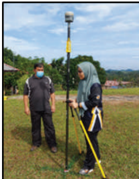
Gambar 6: Penggunaan peralatan GNSS di lapangan bagi penyediaan titik kawalan bumi (GCP)
