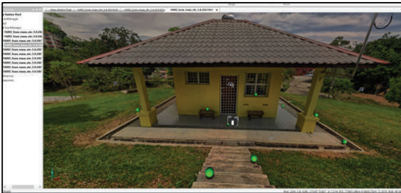
Gambar 9: TLS dan target sphere diri siap di lapangan Sumber: Perisian Scene
